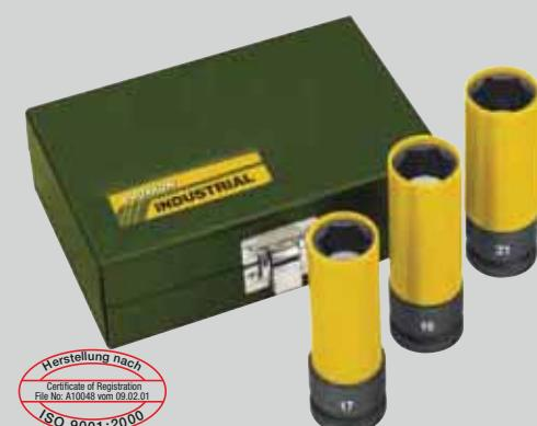
Для использования с пневматическим инструментом на 1/2" (12,5 мм). Из высоколегированной специальной стали с высокой износостойчивостью. Максимальный крутящий момент 500 Нм. Длина 85 мм. В стальном окрашенном футляре
