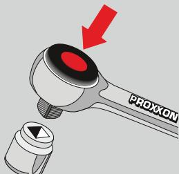
Изготавливается из единой заготовки хром-ванадиевой стали, закалена. Одновременное зацепление сразу нескольких зубцов из 52 передает максимальный момент. Механизм быстрого извлечения: сбрасывает насадку при нажатии кнопки.
